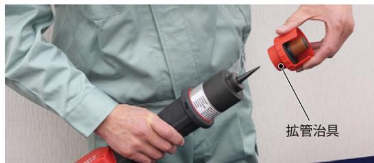
① 拡管するパイプサイズに合う拡管治具を拡管機に装着し、最後まで締め込みます。
