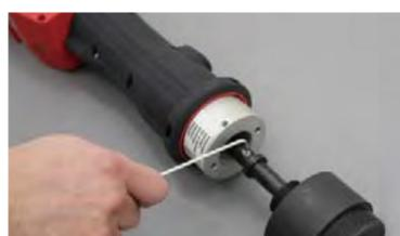
⑤ 拡管するサイズのニードルと本体を接続しボルトを締めます。
