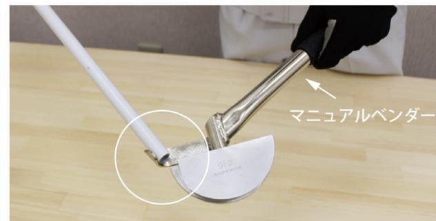
① 図のようにパイプをマニュアルベンダーのパイプ挿入口に沿わせパイプを挿入してください。
