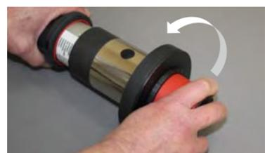
① 装着済みの拡管治具を外します。
