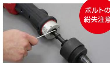
④ ニードルと本体を接続するボルトを外しニードルを抜きます。
