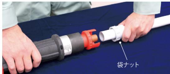
③ 拡管前にパイプに袋ナットを挿入し、パイプを拡管機の拡管治具に挿入します。
