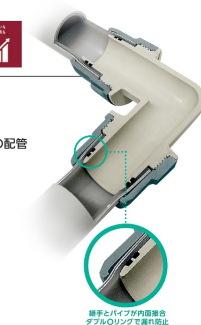
継手とパイプが内面接合ダブルリングで漏れ防止
