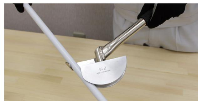
② 図のようにパイプを作業台等の平らな面に置き、マニュアルベンダーを下方方向に押し付けながらゆっくりと手前方向にハンドルを倒してください。
