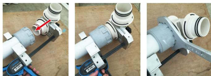
④ 袋ナットの締め込み後、パイプ固定部の解除レバーを押してパイプ固定部を引出し、パイプを外してください。
