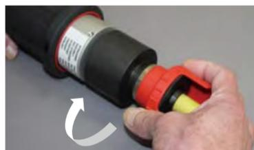
⑧ 使用するサイズの拡管治具を取り付けます。
