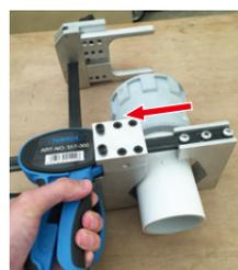
③ 継手を継手固定部に入れてください。継手固定部のレバーを引いてパイプに継手を挿入してください。
